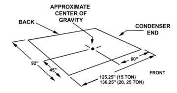
**FIGURE 12 - CENTER OF GRAVITY**
